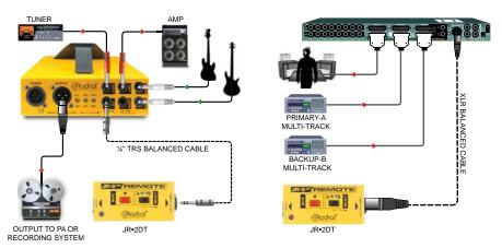
JR•2DT WITH RADIAL FIREFLY TUBE DIRECT BOX
